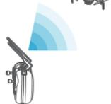
ドローンが送信機の真上の高空で飛行している時、アンテナの角度が適切ではないため、通信に支障をきたします。飛行高度を下がり、もしくは水平方向へ速く飛行させてください。また、図のように送信機のアンテナをドローンの方向に向けてください。
